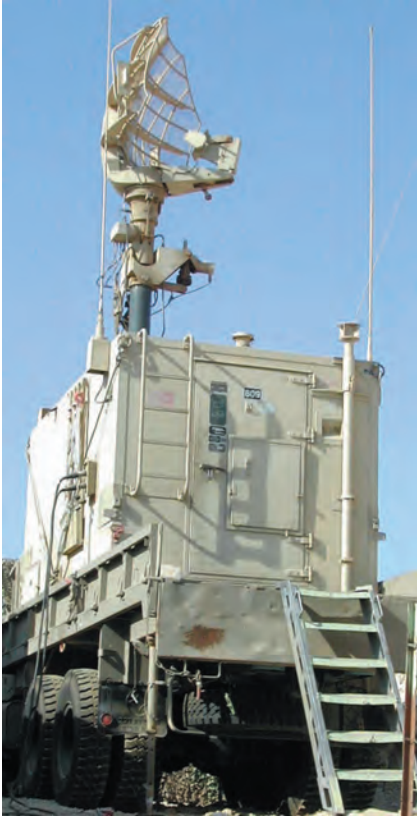
מכ"מ "רמית" הופעל על ידי כוחות הנ"מ בבסיסי חיל האוויר והיה מכ"מ גדודי לגילוי מטוסים ומסוקים מנמיכי טוס. המכ"מ היה בשירות משנות השבעים עד שנת 2000
