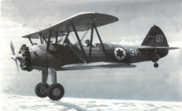
סטירמן PT-17 קיידיט - מטוס אימון דו מושבי מתוצרת "בואינג", שנרכש בשנת 1949 ושימש מטוס אימון עיקרי במשך כ-15 שנים. המטוס בנוי שלד קורות מתכת מצופה בד וצבע, קל להטסה (פרט לנחיתה) ושימש כמטוס הראשון של הצוות האירובטי של ביה"ס לטיסה בשנות ה-50.
