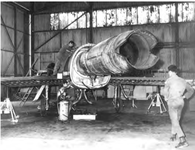
1964. סמב"ד בשיפוץ בטייסת תחזוקה בחצור. בתמונה, חלקו האחורי של המנוע אטאר 101G הבעייתי, בעל המבער האחורי
