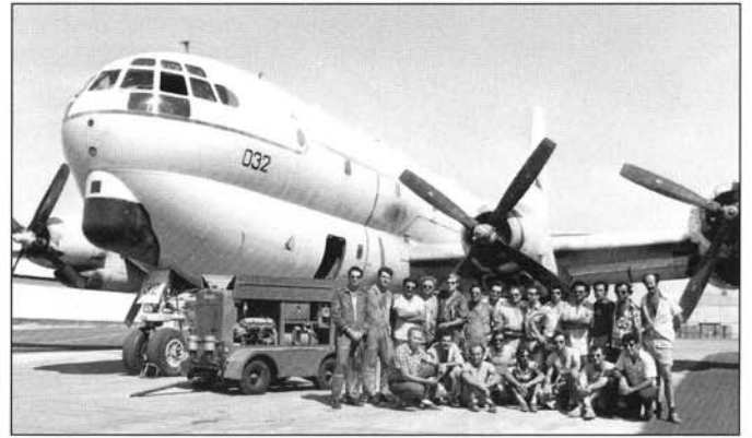
A/c 03 served for special operations, here with some of the pilots and the ground crew of the IAI. Note the Propellers square tips and the luck of spinners. © תמונה: ביעף - כתב עת לתעופה וחלל
