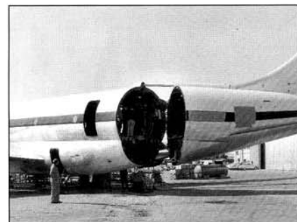
שלושה שלבים בפתחת זנב מטוס הסטראטוקורזר. תמונות: אוסף רמי סקלדמן
