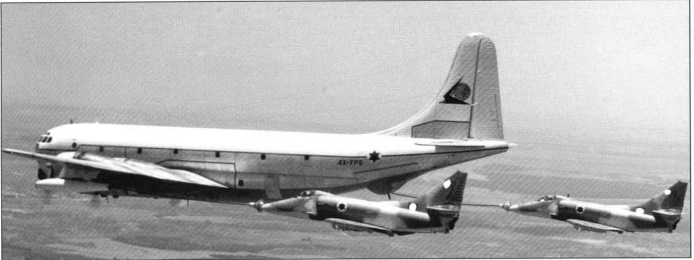
מטוס מספר 037 הינו המתדלק הראשון ונושא שני מיכלי תדלוק. בתמונת למעלה משמאל המטוס מתדלק שני מטוסי סקיהוק דגם H של טייסת הדרקון המעופף. ניתן לראות שהמטוס גם מצויד בבועת התדלוק ללא הבום. תמונה: אוסף אשר רוט
