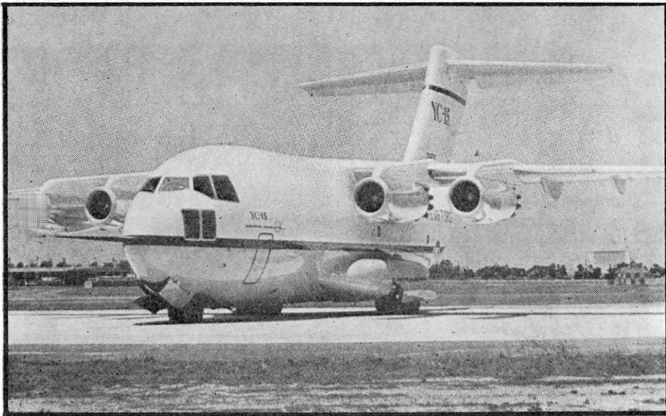
YC-15 הוא מטוס התובלה הראשון שנעשה בו שימוש בטכניקת המדפים הננשבים חיצונית, לשם קיצור מרחקי ההמראה והנחיתה. ממדיו דומים לאלה של דייסיי, אך הגוף רחב ביותר.
