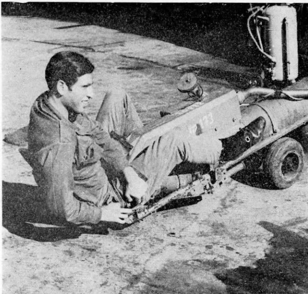
„תותח“ זה הינו בקבוק אויר דחוס להתנעת מנוע המירז'. באמצעותו מסובבים את גל המנוע.
