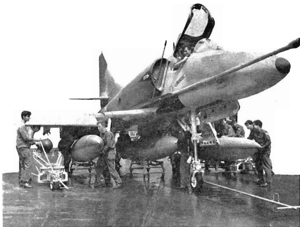
על חמש נקודות התלייה של הסקייהוק — שתיים בכל כנף ואחת בגחון — ניתן לתלות תצורות חימוש מגוונות. בתמונה — הטענת מיכלים נתיקים ופצצות. למעלה, סקייהוק יוצא לטיסה.
