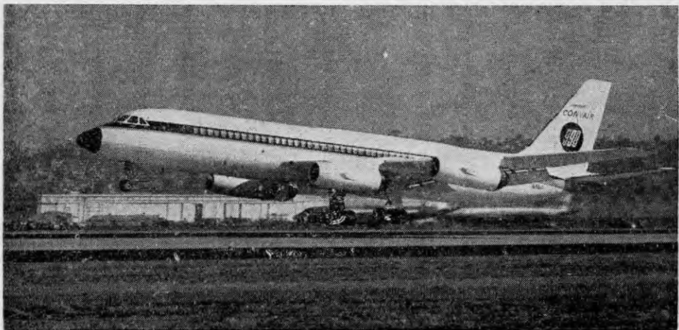
המהיר במטוסי-התובלה כיום (כ-640 מיל בשעה, או 1030 ק"מ בשעה) הוא הקונקוור 990. מנועיו הם מטיפוס "המניפה". המטוס אינו מתוכנן לעבור את מהירות הקול.
