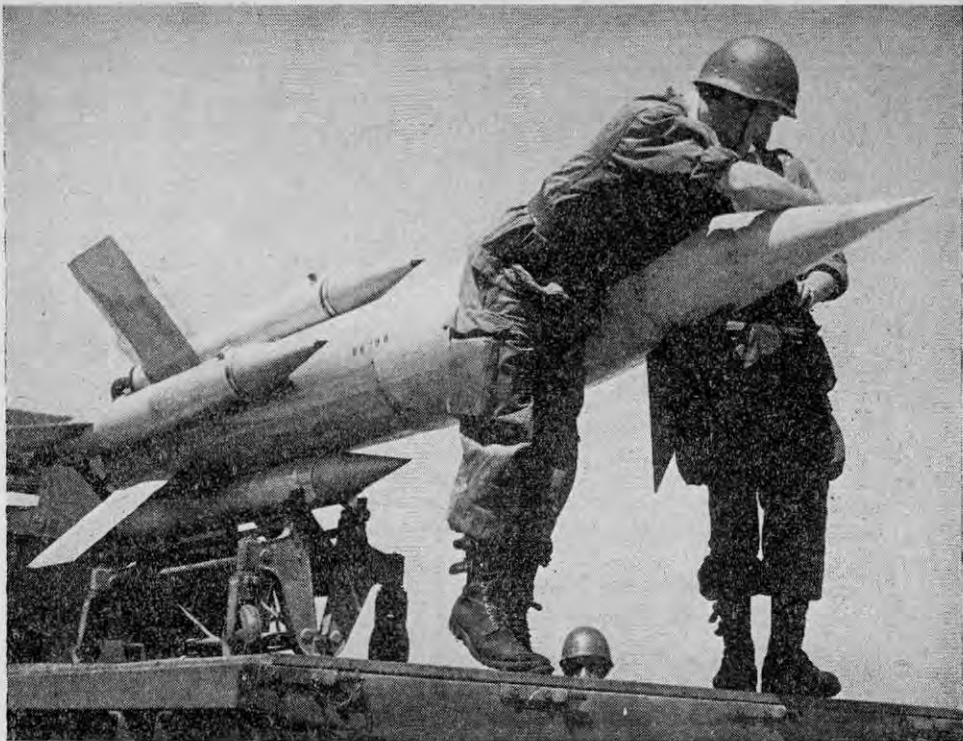
חיילים מכוחות היבשה של צרפת מתקנים לשיגור אחד מטילי קרקע-אוויר „פארקא“, המואץ בעזרת 4 רקטות נתיקות בנות דלק מוצק העוטרות את גופו.
