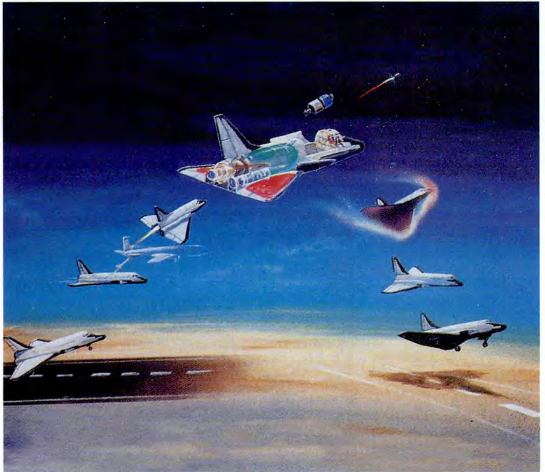
חצי מעבורת, חצי מטוס: הפאת'פינדר תמריא כמו מטוס. לאחר תירדוק באוויר, יוצתו המנועים והמעבורת תאיץ לחלל. הנחיתה תתבצע כמו במעבורות החלל הקיימות
