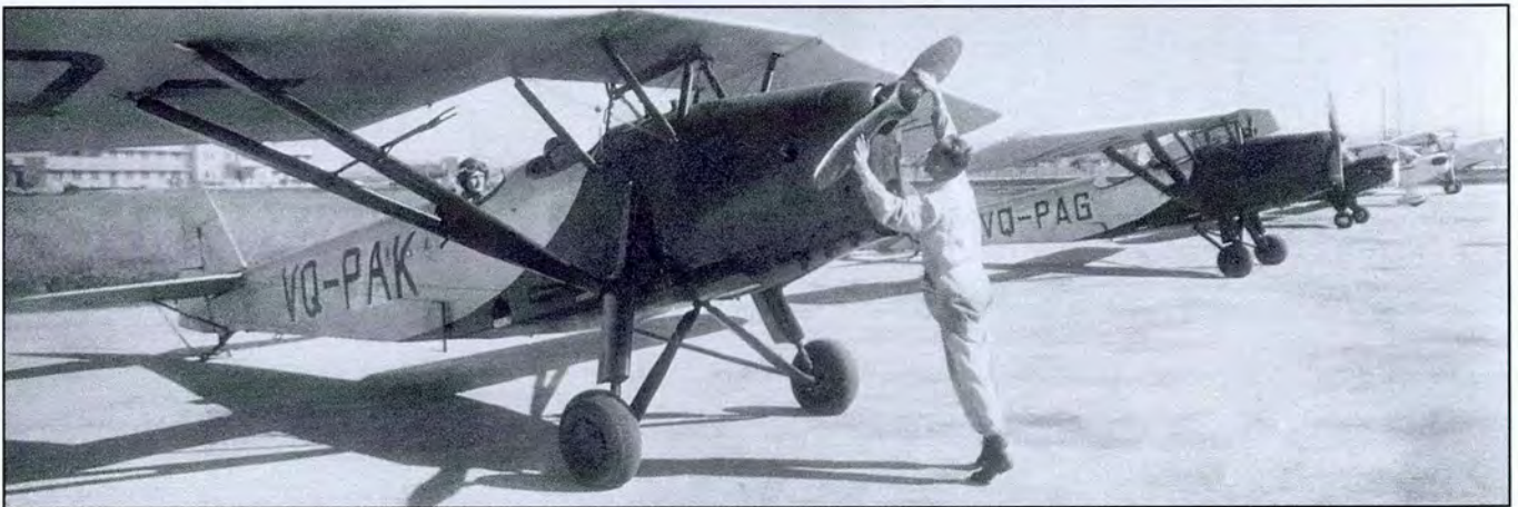
למעלה: כך מתניעים: חניך אחד מסובב את המדחף, והשני לוחץ על מתג ההתנעה. למטה: שיעור בתורת המנוע. סמוך לרפת, מסביר לחבריו החניך פוהויליה, מהנדס בהכשרתו, על מנוע ה"גייפסי" של מטוס ה-RWD-8
