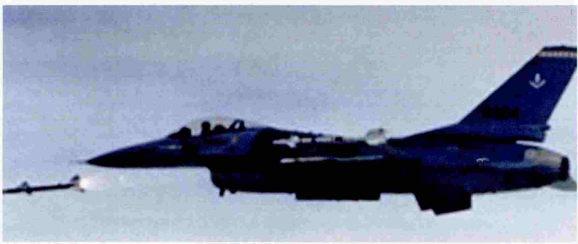
טיל אמראם משוגר מ-F-16 של חיל האוויר האמריקאי. למעלה: הצתת מנוע הטיל. באמצע: האמראם מתנתק מכנף המטוס. למטה: בתוך שניות מעטות, יאיץ הטיל למהירות של יותר משלושה מאך
