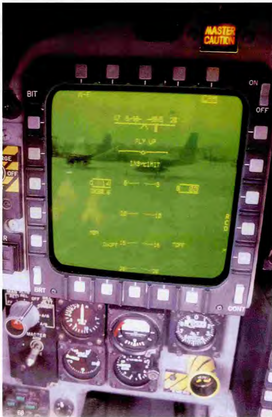
דסקטיות בשימוש: צג רב-תכליתי המותקן בשני תאי הטייס של ה-F-15E
