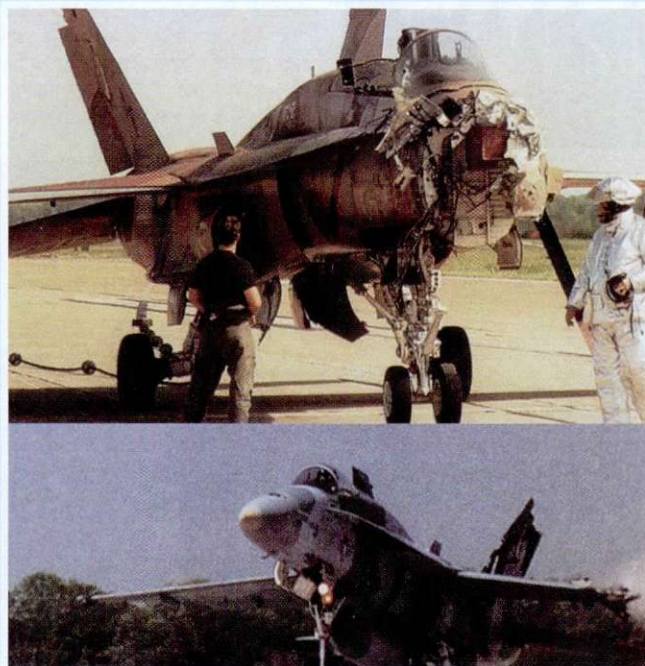
שני מטוסי F-18 של הצי האמריקאי התנגשו בעת אימון מעל האוקיאנוס. מטוס אחד איבד 2.25 מטר מהכנף, 1.35 מטר מהזנב. השני איבד את החופה והחרטום. הטייסים לא נפגעו, וטסו 110 ק"מ, במהירות 270 קמ"ש, לפני שנחתו בבסיס הקרוב
