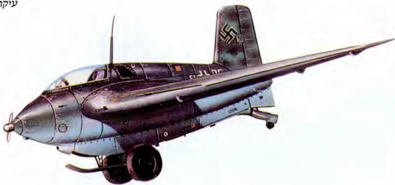
המסרשמיט 163 "קומאט" נבחן לראשונה שימוש מבצעי בהנעה רקטיית במטוסי יירוט. במטוס זה נבחן לראשונה עיקרון הכנף המעופפת
