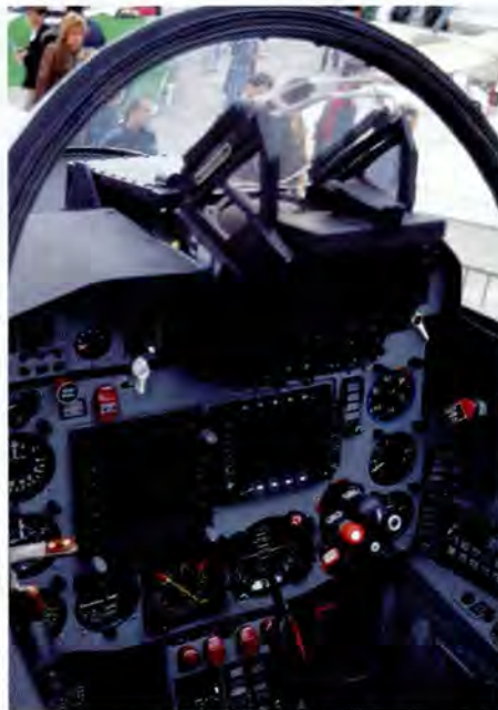
מבט מקרוב על הקוקפיט של המיג-21, שעבר השבחה בתעשייה האווירית. ערכות ההשבחה "כיכבו" השנה בסאלון ללא עוררין, והעידו על המגמה הרווחת בתעשיית התעופה העולמית
