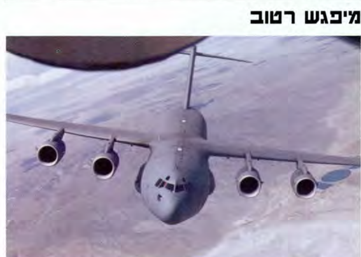
17, מטוס התובלה העתידי של חיל־האוויר האמריקני מתוצרת "מקדונל דגלאס", ערך לאחרונה ניסויי טיסה מתקדמים לקראת קליטתו. בתמונה: המטוס הראשון מקריהיצור של ה־17C מתכוון לביצוע ניסוי של תדלוק אווירי ממטוס KC-135
