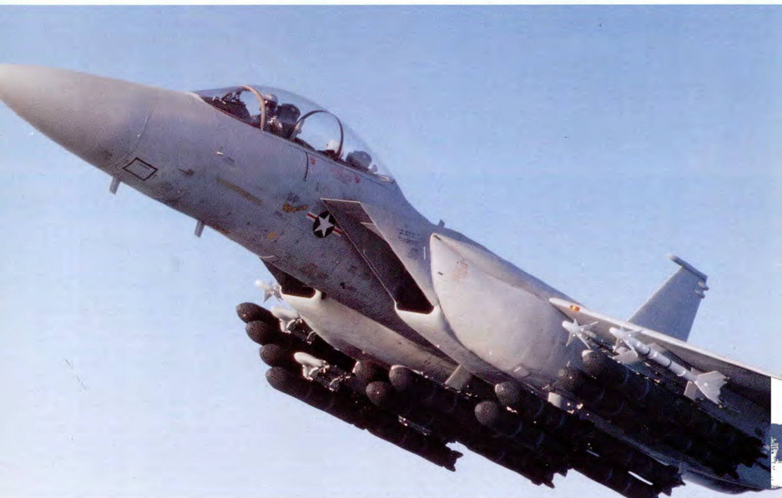
קיבולת עצומה: כמות החימוש שניתן להעמיס על ה-F-15-E שווה כמעט למשקל המטוס כשהוא ריק
