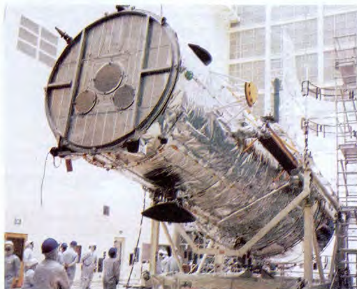
דלת הגישה הראשית של ההאבל מאפשרת לבצע תיקונים בשעת-הצורך. משלחת אסטרונוטים תשוגר ב-1994 לתיקון הפגמים שהתגלו
