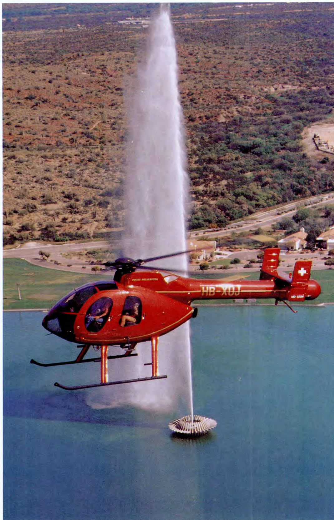
נטול רוטור: MD-520 נוטאר מתוצרת "מקדונל דגלאס הליקופטרים", המסוק ללא רוטור אחורי, יצא למטס דאווה באריזונה, לאחר שצבר עד כה למעלה מ-160 זמנות. כעת משתמשות בו מדינות שונות באירופה, אסיה, קנדה ודרום-אמריקה
