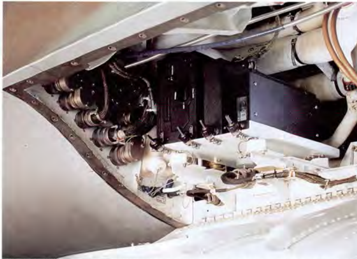
הכרטיס כבר בפנים. מערכת ה-ACE לתחקור קרבות אוויר מותקנת על F-16 של חיל-האוויר הישראלי
