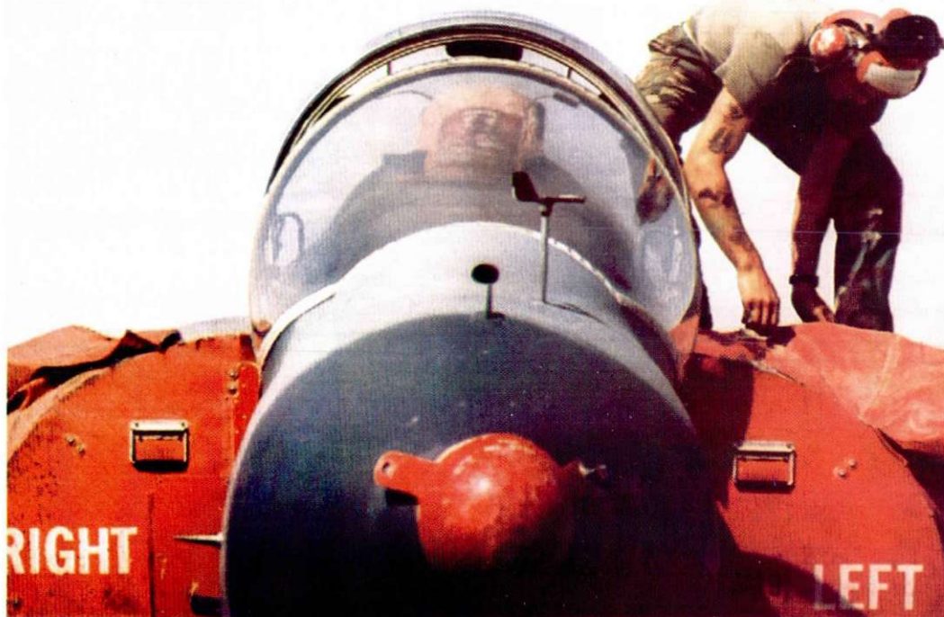
הארייר של המארינס מקבל טיפול נגד חול ואבק, מיד עם נחיתתו בסעודיה: כוסי האוויר מכוסים כדי למנוע חדירת גופים לא דצויים למנוע
