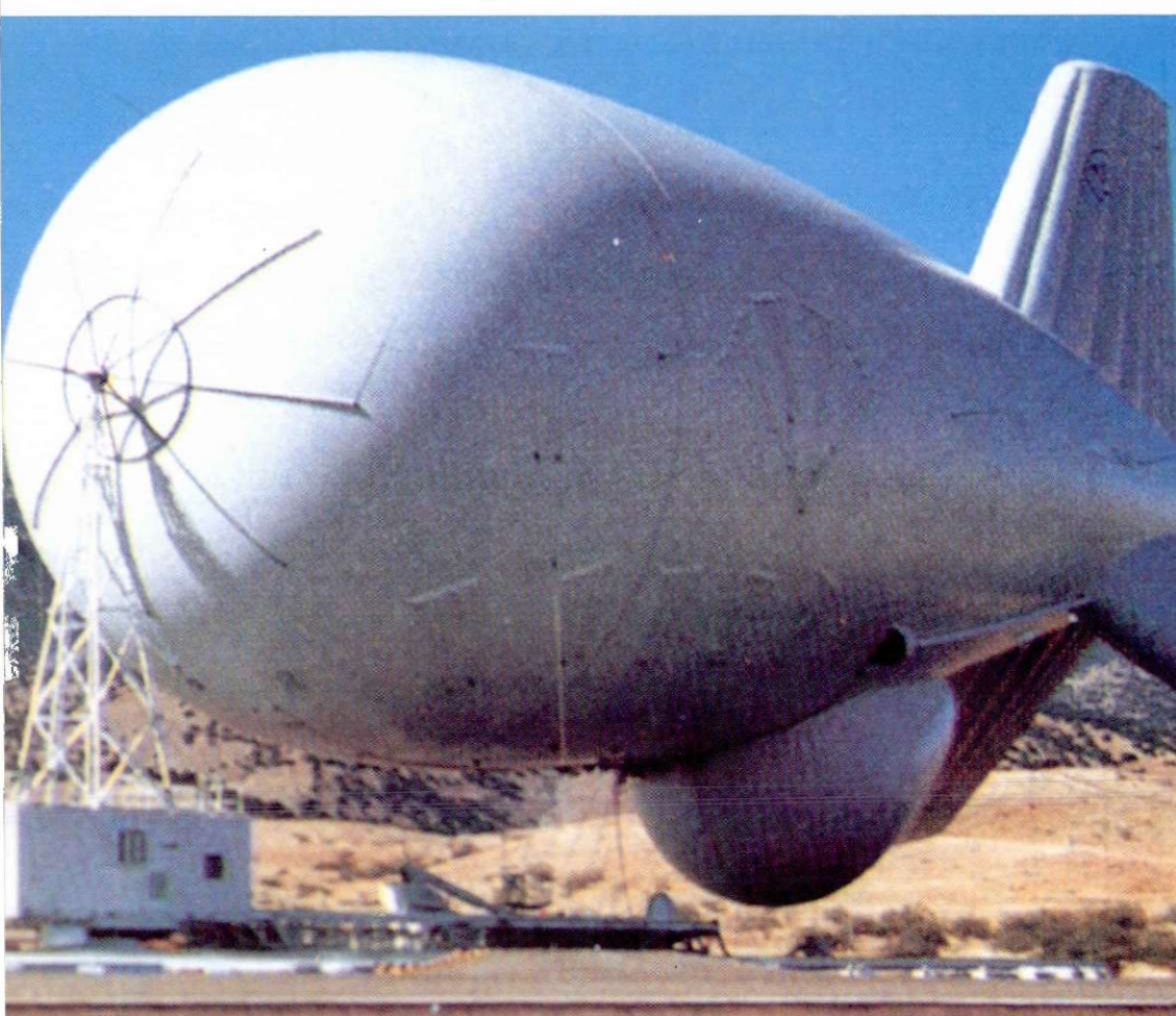
זהו בלון LASS (מערכת גילוי לגובה נמוך) TPS-63, מתוצרת TCOM, שהתריע על הפלישה העיראקית המתקרבת והציל את האמיר של כוויית. אורך הבלון כ-70 מ' והוא מצולם כאן בארוונה
