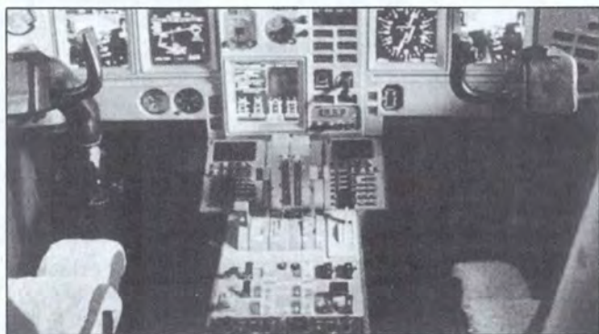
IL-114 - חשיפה ראשונה - הקוקפיט שבתצלום לא שייך לגרסה החדשה של הבואינג 747 או של ה-767, אלא למטוסי-נוסעים סובייטי חדש אך קצר טווח יחסית. ה-114 לו מפתיע בעקרונות התכנון המתקדמים, שהינחו את מפתחי תא הטייס: חמישה צגים צבעוניים, התואמים את עקרון ה"תא המוצל" (DARK COCKPIT), ממוקמים לפני זוג הטייסים, וסביבם מעט מאוד שעונים אנאלוגיים.
