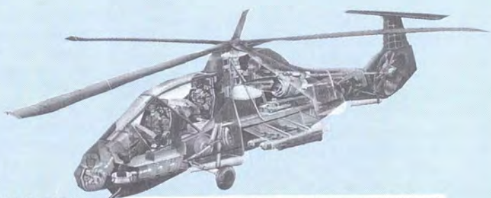
ב'מוק'אפ' ה-LHX של בואינג / סיקורסקי (בתמונה) מתנקזים גזי הפליטה של המנוע דרך קורת-הזנב
