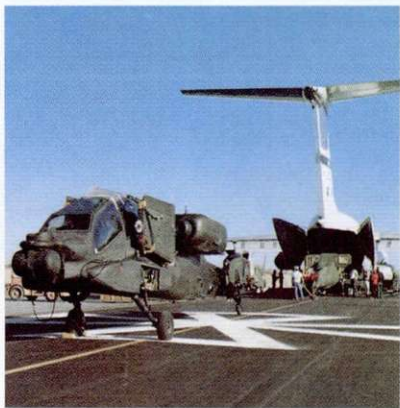
יביל-אוויר אמיתי: מקפלים את כנפי הרוטור ומכניסים פנימה, אלתור היסטאר ליפטור
