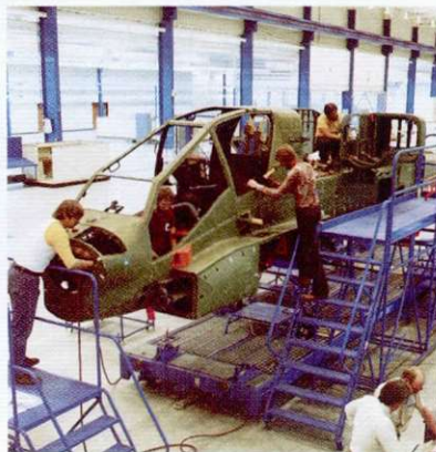
הרכבת הגוף של המסוק, במפעלי "מקדונל-דגלאס הליקופטרים" באריוונה
