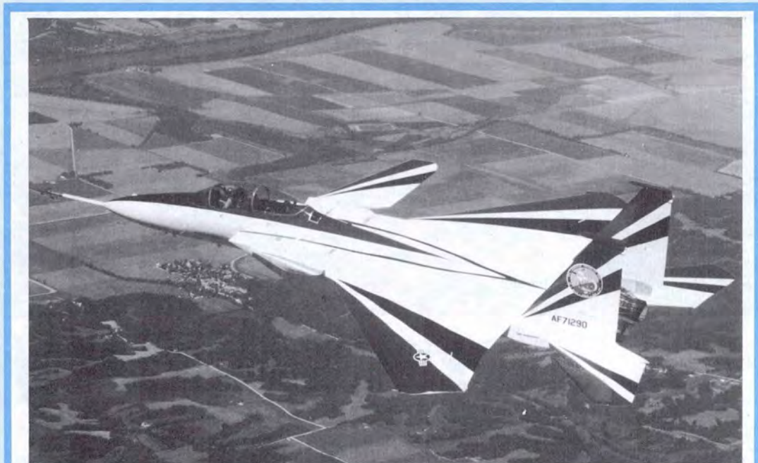
F-15 עם קנרד F-15 S/MTD, דגם המיועד להדגים יכולת המראה ונחיתה משדות פגועים. בתמונה שלב ראשון בניסויים: הקנרד הנע. בשלב הבא, יוחלפו המנועים במנועי דחף מתכוונו. למטוס מערכת טיס על-חוט ובקרת טיסה והנעה משולבות
