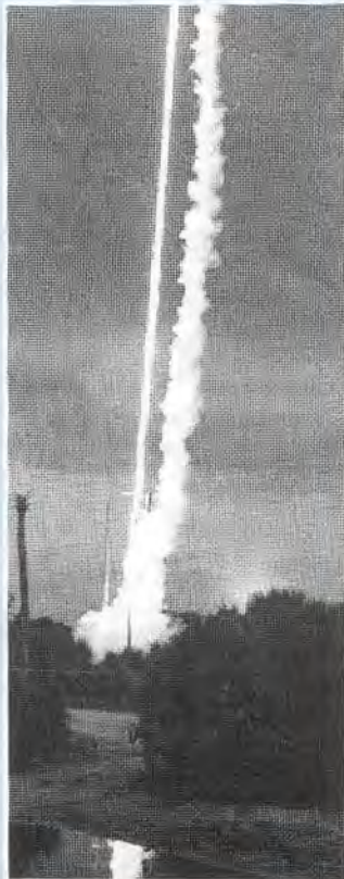
חקר ברקים. חוטי הנחושת מתלהטים כשזכרבק עובר דרכם
