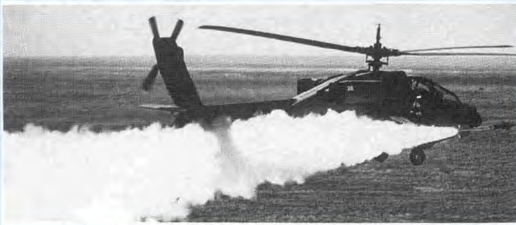
שיגור טיל אוויר-אוויר סייד ווינדר מה AH-6 Ha אפאצ'י. בהמשך הניסויים יבוצע שיגור טילי מיסטרל וסטינגר
