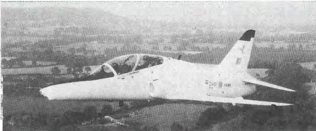
הוק-100 של בריטיש אירופייס החל את ניסויי הטיסה שלו. כפי שנואה בתצלום חרטום המטוס הותאם לנשיאת FLIR, אמצעים לראיית לילה, מצוין מטרות ומערכות כיוון חימוש מתוחכמות
