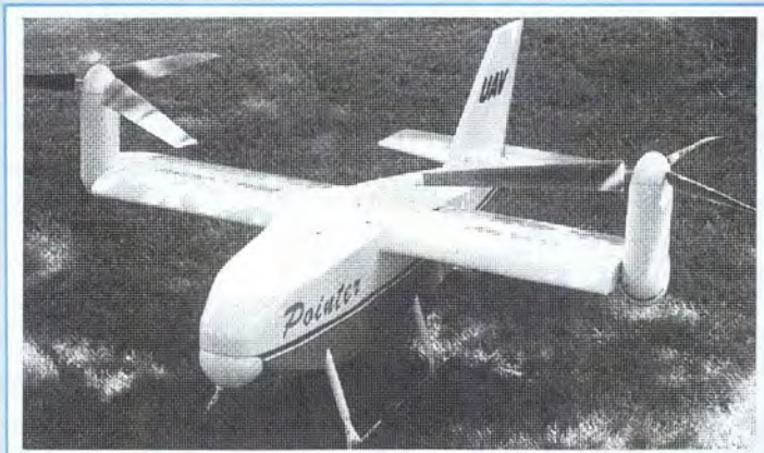
מזל"ט טילט רוטור דגם מוקטן לחצי למזל"ט טילט רוטור "פוינטר", מתוצרת חברת "בל" ו"בואינג". החברות, המפתחות את ה-V-22, מבקשות לנצל יתרונות מטוס-מסוק גם במזל"טים. נוח לתפעול, אינו מצריך אמצעי שיגור והנצלה ובעל יכולת שהייה והגעה מהירה למטרות. בניגוד ל-V-22, המנועים בפוינטר נמצאים בגוף ורק הפרופלר נע סביב צירו ב-90 מעלות.
