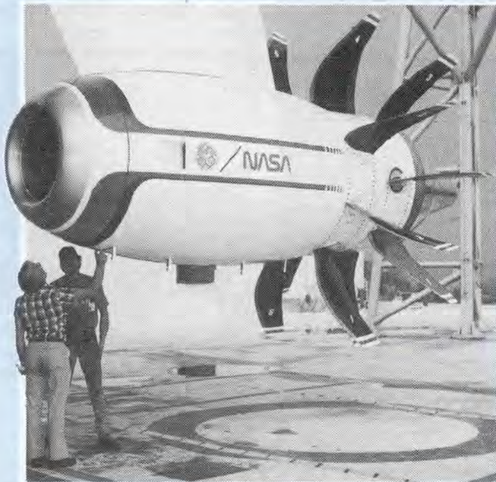
מנוע אנדקטד-פאן פיתוח נאס"א וג'נרל אלקטריק, 25 אחוז חסכון בדלק
