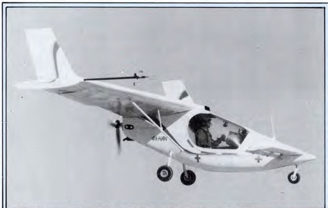
אמביט - מטוס קל מתוצרת ישראל, הוצג בסוף מארס. המטוס הוא מתוצרת חברת "סאייקופט" ומחירו כ-30 אלף דולאר. הגאמביט מוצע למכירה כקיט להרכבה עצמית. זמן ההרכבה מוערך ב-300-400 שעות לאדם לא מיומן, זמן הנחשב קצר יחסית. טווח הטיסה של המטוס - 400-600 ק"מ.
