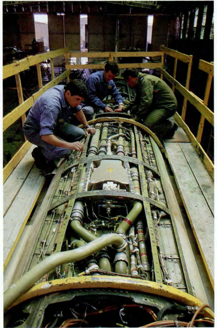
למעלה: כל הצנרת ההידראולית הוחלפה. למטה: דגש על תחזוקתיות (צילומים: אסף שילה)
