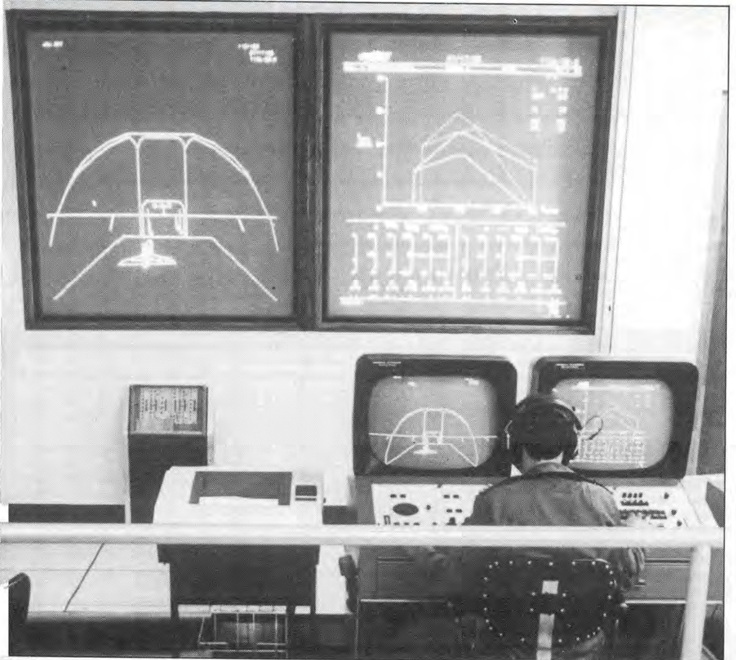
לוחות התצוגה של המיתקן ועמדת המפעיל. על הלוח משמאל מבט מתוך תא הסקייהוק, מימין - גראפים ונתוני טיסה
