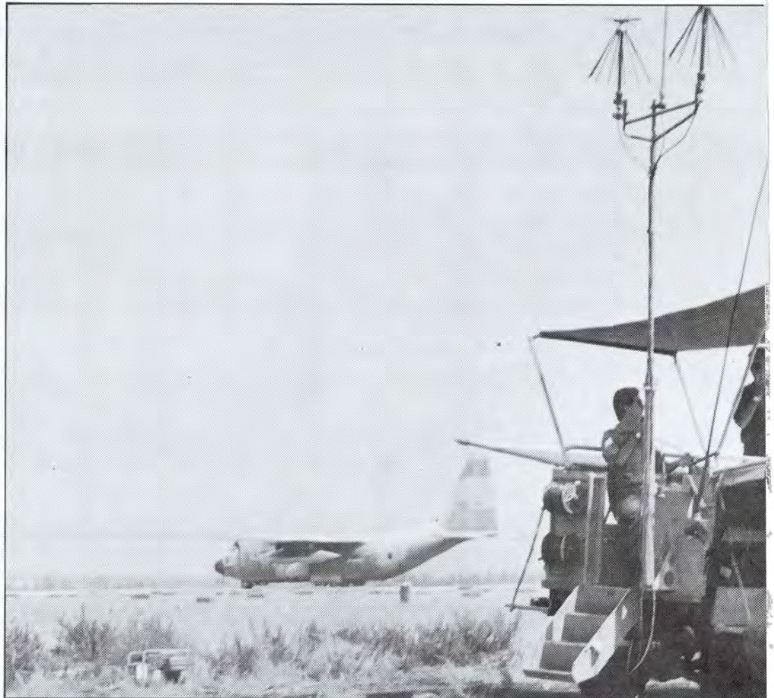
ATC-4950, מגדל פיקוח נייד על ג'יפ מתוצרת E.C.I.
