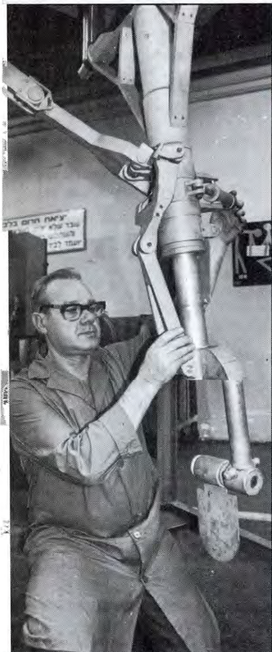
אחד מכני הנסע האחוריים של הלבאי נבדק בקפידה לפני שיורכב על מתקן הניסוי שיבדוק את חוקו ואמינותו
