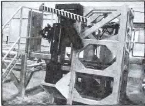
מתקן זה מדמה בעזרת בוכנות רבות עוצמה את הלחץ שיופעל על כנפוני הקאנארד הנעים של הלבאי
