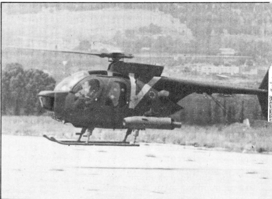
דיפנדר: נראה כמו טיפת מים מוטלת על צידה, שאליה צמודים מגלשים, רוטור וחבום הכולל את יחידת הזנב
