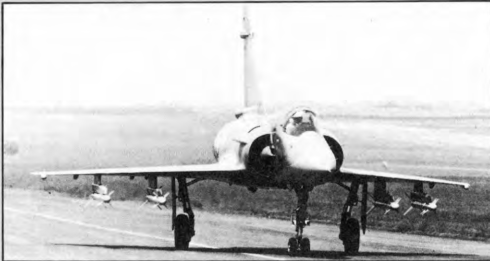
מבט מלפנים: שים לב להתמזגות הכנף-גוף ולכנפוני הקנארד הקטנים מטוס שאין בו אף קו או בליטה מיותרים
