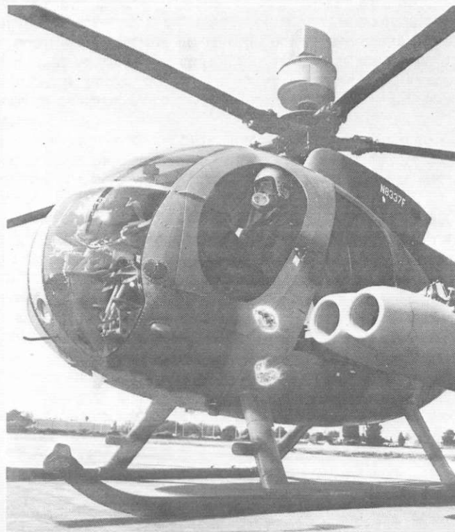
הדיפנדר של "יוז", שעליו מורכב MAST MOUNTED SIGHT
