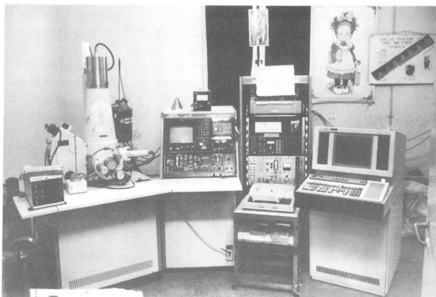
מערכת המיקרוסקופ: משמאל — העמודה, במרכז — מערכת התצוגה ומסוף המחשב, משמאל — מערכת אנליזה של קרני איקס, מתוצרת ישראל
