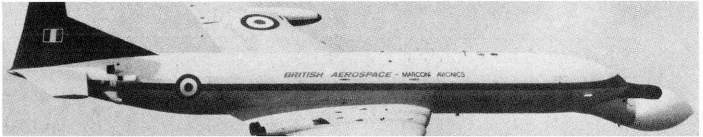
הקומט האזרחי של BOAC, המשמש כמיטת ניסויים לבחינת המכ"ם הקדמי של הנימרוד AEW
