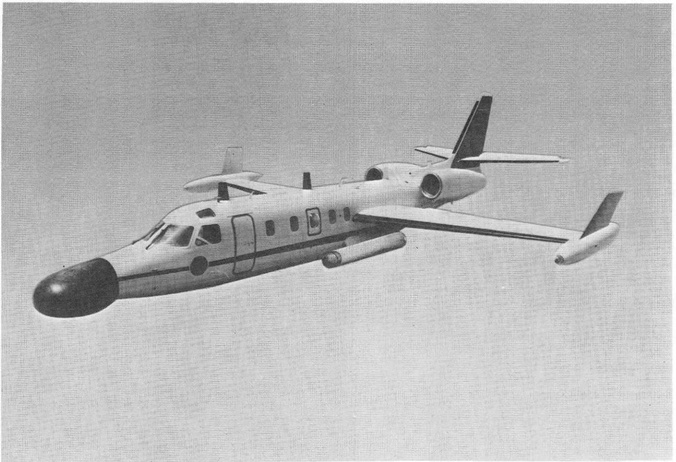
ציור דגם הסי-סקאן לשנות השמונים. למטוס כנף משופרת ומשטחי קצות-כנף המשפרים את ביצועיו
