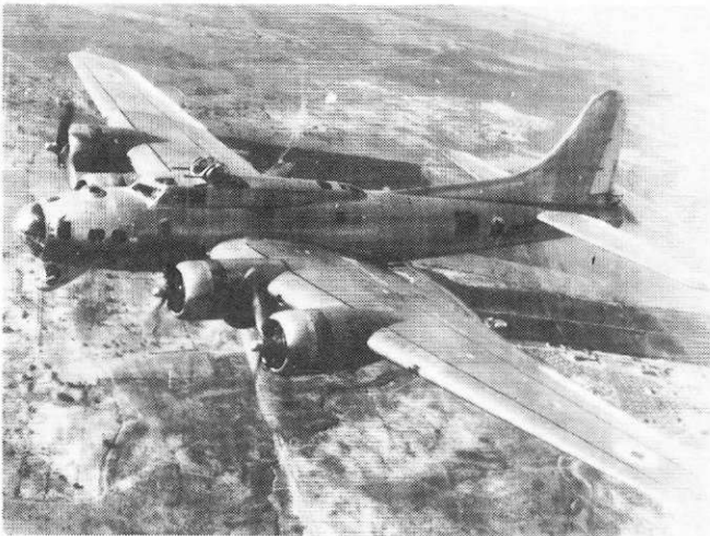
כרי לשמש כמטוס סיור ימי הוסב דגם הסיור של מפציץ ה-B-17 שהיה לחיל-האוויר. בחרטומו הותקן מכ"מ התראה יבשתי מעורפי מלח-מת העולם השנייה ועמדת צופה (על כל צרה), שכללה משקפת רבת-עוצמה
