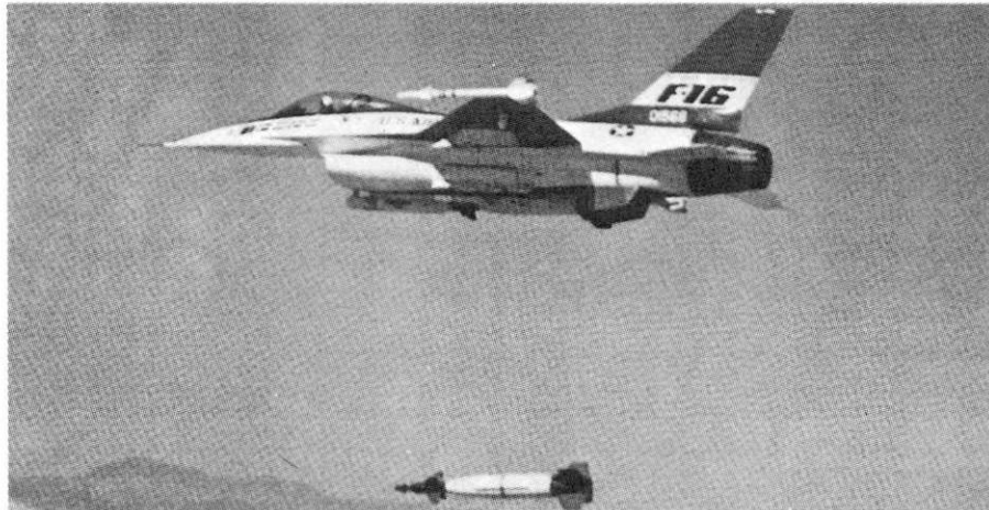
F-16 משחרר פצצות 'חכמות' מונחות-לייזר GBU-10. מתחת לגחון המטוס ניתן להבחין במינשא סמן-לייזר 2 ATLAS, המשמש להנחיית הפצצה
